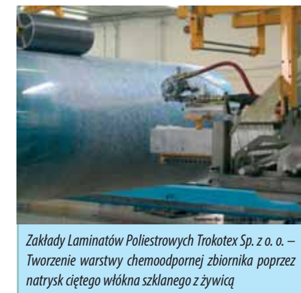
Zakłady Laminatów Poliesterowych Trokotex Sp. z o.o. – Tworzenie warstwy chemoodpornej zbiornika poprzez natrysk ciętego włókna szklanego z żywicy
